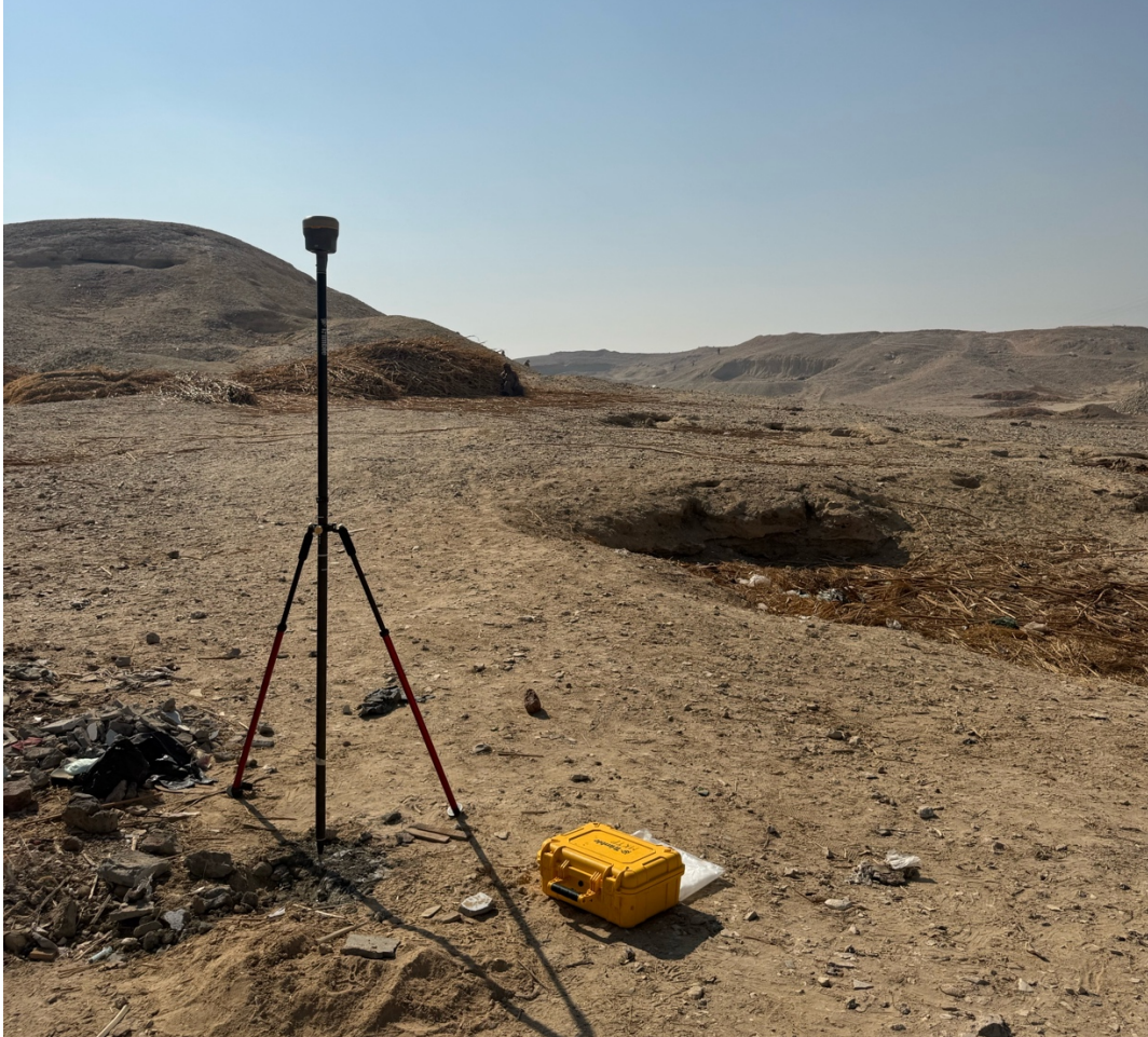
شكل ٤: إنشاء شبكة الموقع ونقاط التثبيت في أنحاء دير البلاص.
